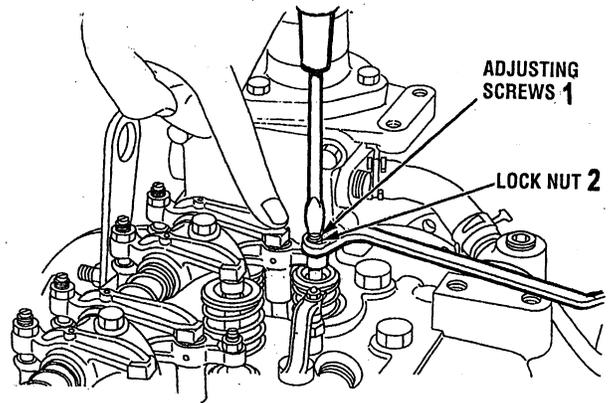
**VALVE CLEARANCE FACTORY SPEC. 0.23 - 0.27MM
